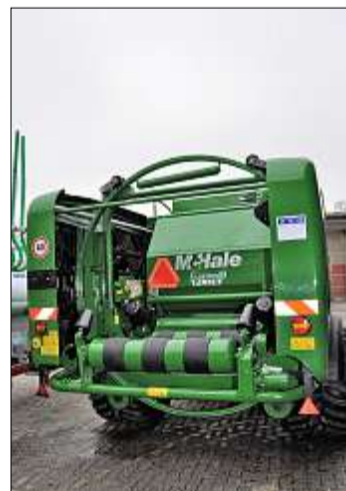
Der vertikale Wickelring sorgt für zügiges Wickeln.
