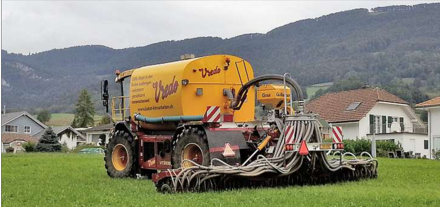
Der Gülle-Selbstfahrer mit der selbst entwickelten 8,4-m-Anbaueinheit. Damit kann Andreas Bobst gleichzeitig Gülle ausbringen und Getreide säen. (Bild: zvg)
