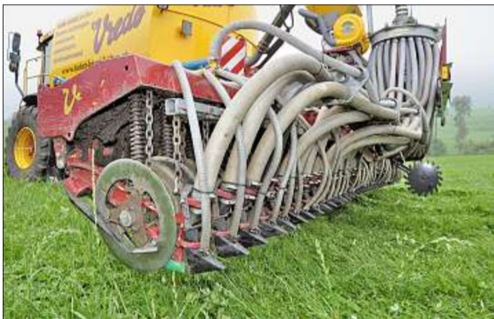
Die Säschläuche sind separat verlegt, so dass der Samen unabhängig von der Gülle in den Gummischuh des Narbendrillers gelangen kann. (Bilder: Heinz Röthlisberger)
