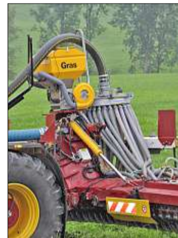
Die Säeinheit stammt von Krummenacher, der Gülleverteiler von Vogelsang.
