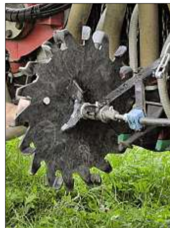
Das Dosierrad stellt sicher, dass immer gleich viel Saatgut in den Boden gelangt.
