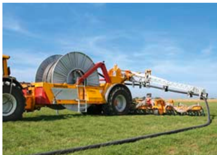
Der «Rotomax-Güllehaspel» von Veenhuis ermöglicht es dank langem Arm, Scheibeninjektoren mit Verschlauchung einzusetzen. Dies könnte auch ein Denkansatz für den Selbstfahrer sein. (Bild zVg)
