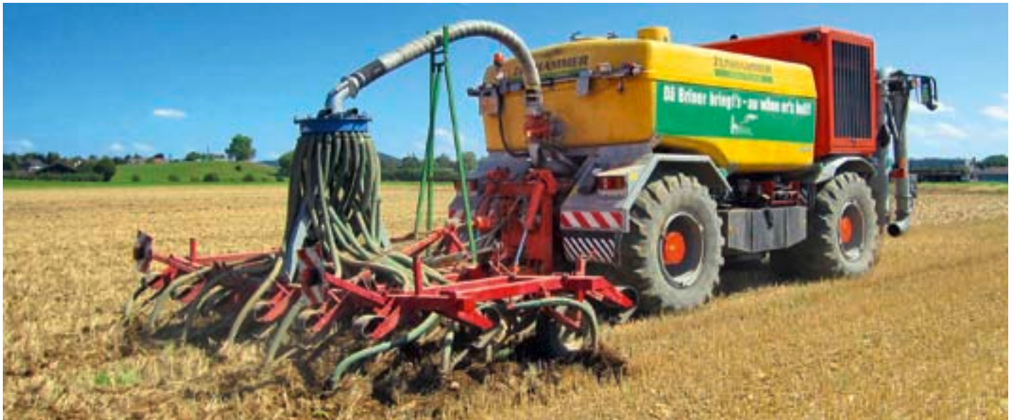
Der Holmer von Peter Briner wird nach der Ernte mit einem Güllegrubber eingesetzt, im Frühling und Herbst auch mit Schleppschlauchverteiler. (Bild: Peter Briner)
