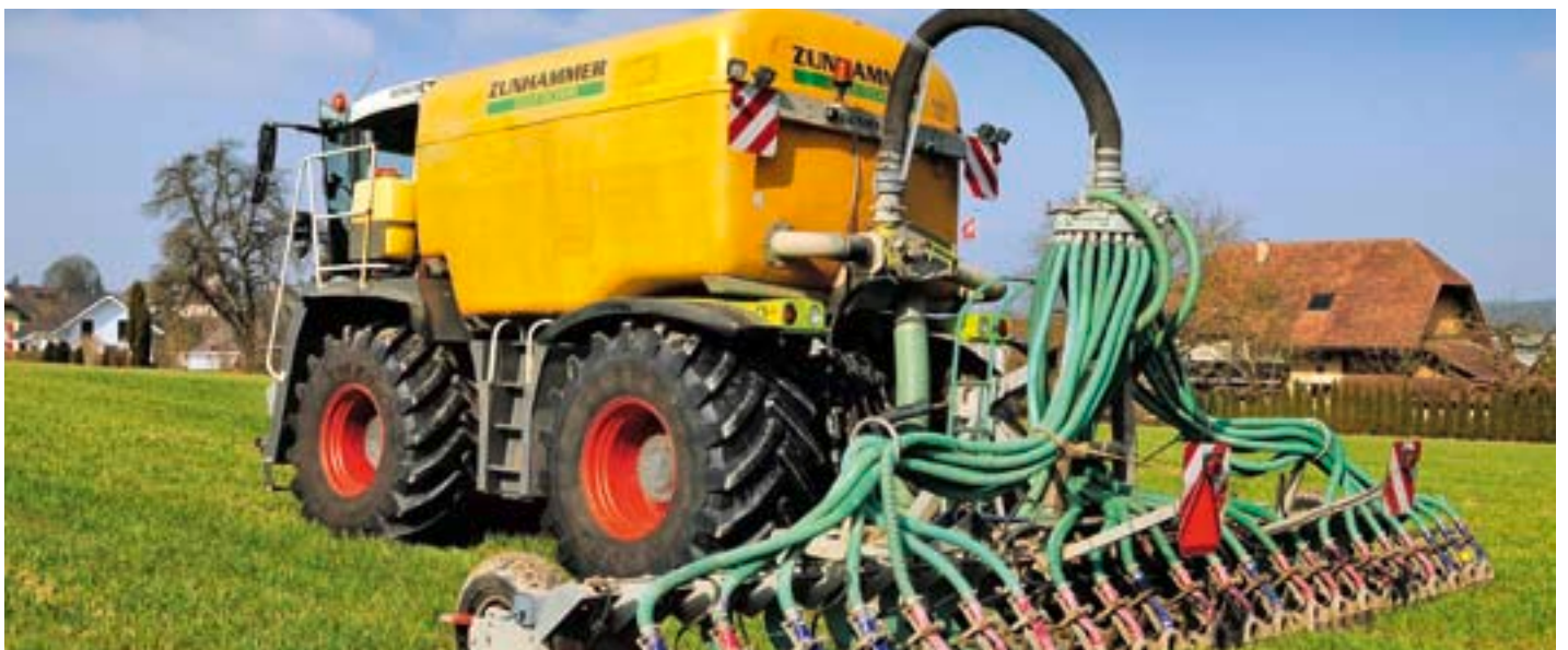
Das Systemfahrzeug Claas Xerion von Markus Schneider kommt mit Scheibeninjektor und Kurzscheibenegge zum Einsatz. (Bild: Ruedi Burkhalter)
