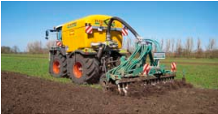
Kurzscheibeneggen erfordern Fahrgeschwindigkeiten von 12 bis 15 km/h und somit viel Motorleistung. (Bild zVg)
