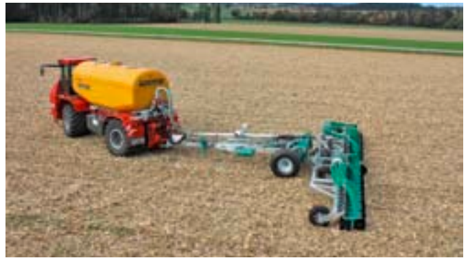
Mit dieser Neuentwicklung, dem angehängten Scheibeninjektor «Zunidrill Mobil», ist es Zunhammer gelungen, die hintere Achslast des Selbstfahrers bedeutend zu reduzieren. (Bild zVg)
