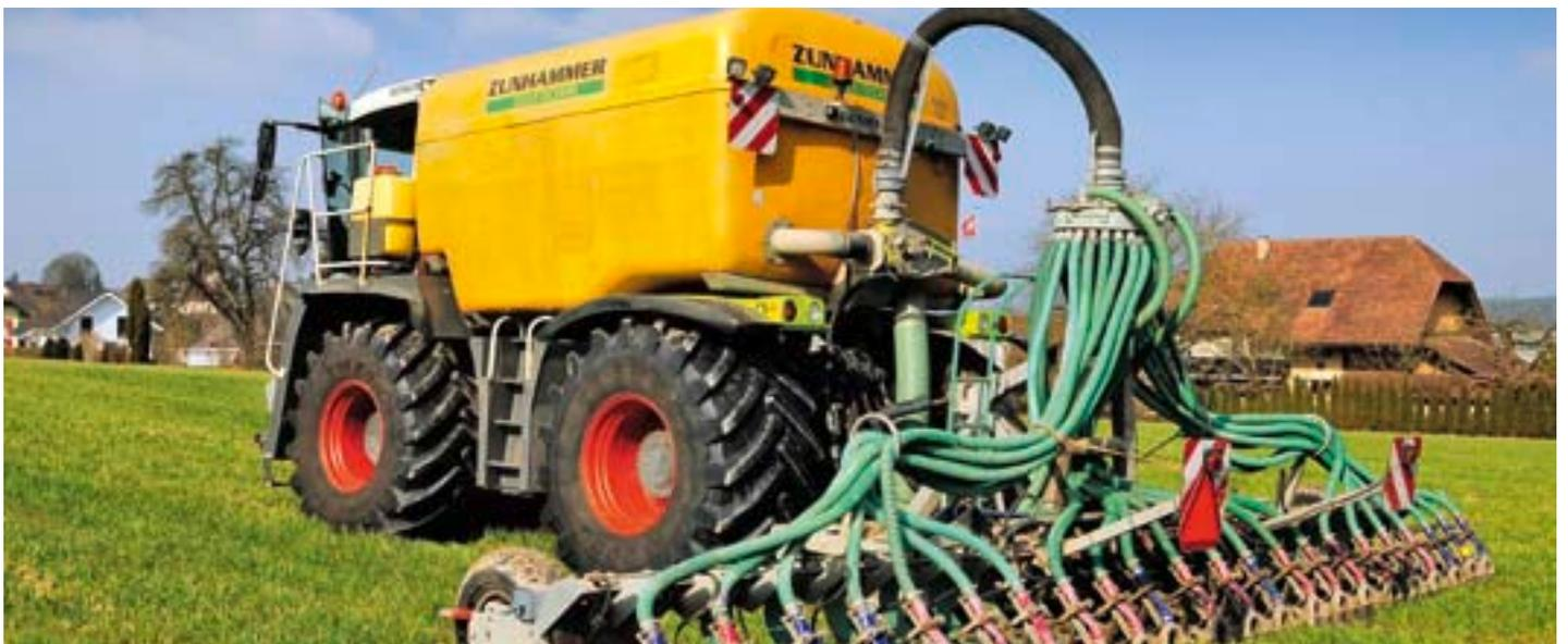
Le véhicule système Claas Xerion de Markus Schneider s'utilise avec un injecteur à disques et une herse à disques compacte. (Photo d'usine)
