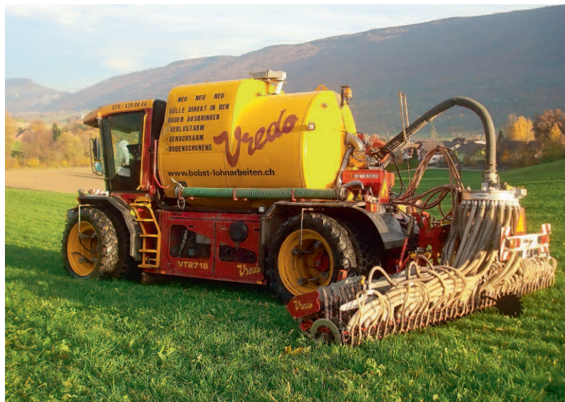
Das Sägerät befindet sich hinter dem Fass. Das Gebläse befördert den Samen über Leitungen zu den 41 Gülleabgängen.
